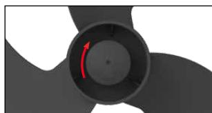
4. Снимите лопасть вентилятора и очистите ее влажной салфеткой.
