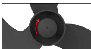
4. Ta loss fläktbladet och rengör det med en fuktig trasa.
