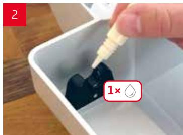
**DE** Silencing-grease ist ein dynamisch mittelschweres, synthetisches Spezialfett zur Minderung von Reibung und Verschleiß sowie zum Schutz vor stick-slip-Erscheinungen.
