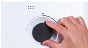
Die gewählte Leistungsstufe wird durch die Anzahl der leuchtenden LEDs über dem Drehschalter angezeigt.
