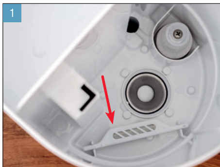
Vložte A7017 Ionic Silver Stick®.
