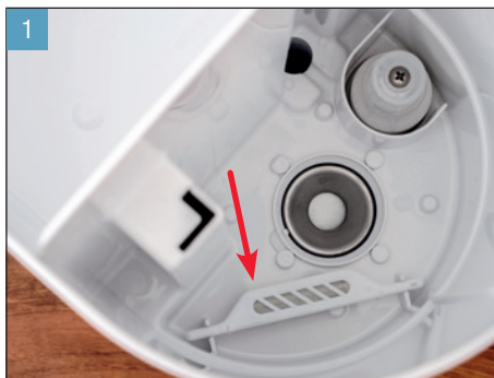
Τοποθετήστε το A7017 Ionic Silver Stick®.
