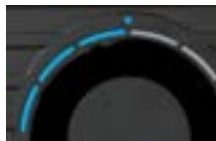
i driftstypen "Humidifier" (Fukting) lyser LED-ene blått
