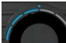
Režīmā "Humidifier" (Mitrināšana) gaismas diodes deg zilā krāsā.
