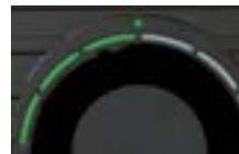
Στη λειτουργία «Purifier» (Καθαρισμός του αέρα) ανάβουν με πράσινο χρώμα οι LED
