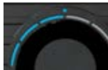
В режиме «Humidifier» (Увлажнение) светодиоды горят синим светом
