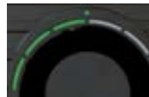
Režīmā "Purifier" (Gaisa attīrīšana) gaismas diodes deg zaļā krāsā.
