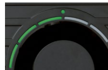
U načinu rada "Purifier" LED diode svijetle zeleno
