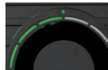
"Attīrītāja" režīmā gaismas diodes deg zaļā krāsā.
