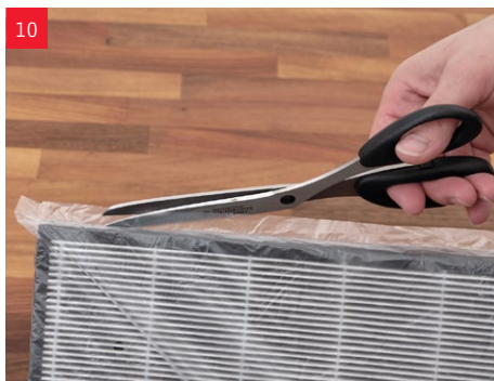
10 Odstranite zaščitni ovoj filtra A681 HYBRID.
