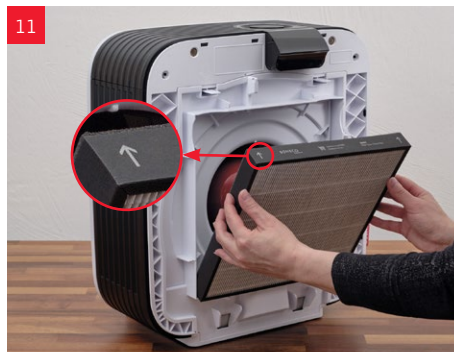
11 Asetage A681 HYBRID-filter kohale (järgige noolesuunda).
